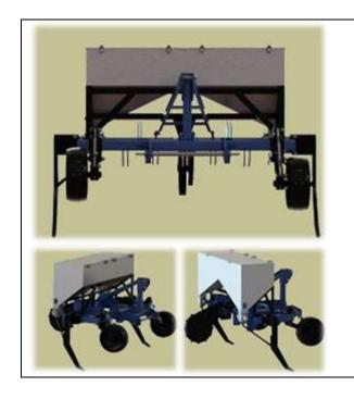
АГРЕГАТ ДЛЯ ВНЕСЕНИЯ УДОБРЕНИЙ ДЛЯ МОЛОДЫХ И МНОГОЛЕТНИХ ВИНОГРАД-НИКОВ. (УСТАНАВЛИВАЕТСЯ НА УНИВЕР-САЛЬНУЮ РАМУ АНВУ-01). ДОЗАТОР ПОЗВОЛЯЕТ РЕГУЛИРОВАТЬ КОЛ-ВО ВНОСИМОГО УДОБРЕНИЯ. ВНЕСЕНИЕ УДОБРЕНИЙ ПРОИСХОДИТ ТОЛЬКО В ПРОЦЕССЕ ДВИЖЕНИЯ.
