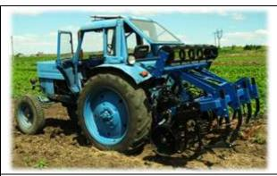
АНВУ-01 АГРЕГАТИРУЕТСЯ С ТРАКТОРАМИ ЮМЗ, МТЗ, ДТ-75. СПОСОБ НАВЕСКИ ОБОРУДОВАНИЯ НА ТРАКТОР: ТРЕХТОЧЕЧНАЯ НАВЕСКА С РЕГУЛИРОВКОЙ НАКЛОНА КУЛЬТИВАТОРА ПРОДОЛЬНО.
