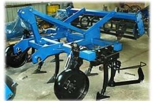
АНВУ-01, С МЕЖКУСТОВЫМ КУЛЬТИВАТО-РОМ, ЗАДНИМ КАТКОМ РЫХЛИТЕЛЕМ, СТОЙКАМИ СО СТРЕЛЬЧАТЫМИ ЛАПАМИ, ОПОРНЫМИ КОЛЕСАМИ С КРОНШТЕЙНОМ И ТАЛРЕПОМ.
