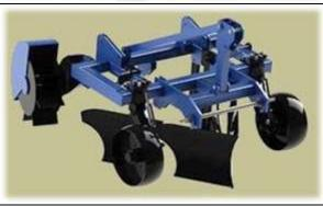
УКРЫВЩИК ЛОЗЫ С РОТОРНОЙ ФРЕЗОЙ (УСТАНАВЛИВАЕТСЯ НА УНИВЕРСАЛЬНУЮ РАМУ АНВУ-01). РОТОРНЫЙ УКРЫВЩИК ПРОИЗВОДИТ КАЧЕСТВЕННУЮ УКРЫВКУ, ВЗРЫХЛЕННЫМ ГРУНТОМ, ВИНОГРАДНИКОВ И ЯГОДНИКОВ В ФЕРМЕРСКИХ ХОЗЯЙСТВАХ, НЕ ИМЕЮЩИХ ТРАКТОРОВ БОЛЬШОЙ МОЩНОСТИ.
