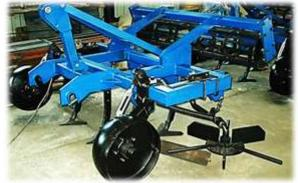
АНВУ-01, С РОТОРНЫМ ОТПАШНИКОМ, ЗАДНИМ КАТКОМ РЫХЛИТЕЛЕМ, СТОЙ-КАМИ СО СТРЕЛЬЧАТЫМИ ЛАПАМИ, ОПОРНЫМИ КОЛЕСАМИ С КРОНШТЕЙНОМ И ТАЛРЕПОМ.
