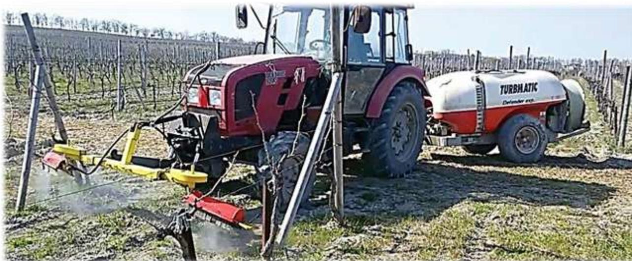
Опрыскиватель гербицидами предназначен для внесения гербицидов непосредственно в приствольные полосы с целью эффективного уничтожения сорной растительности в садах и виноградниках. Устройство состоит из двух секций, одновременно обрабатывающих две приствольные полосы между деревьями и кустами винограда с высокими и низкими штамбами.
